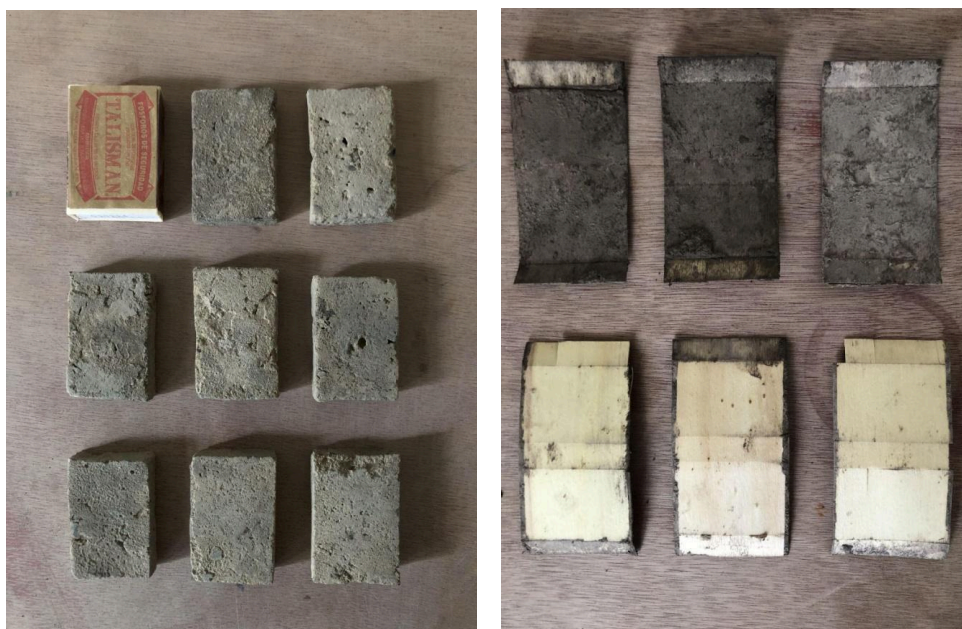
Imagen N° 48, pruebas de resistencia ceniza. Imagen N° 49, cajas de fósforos que fueron utilizadas como moldes. Fotografías de la autora.
