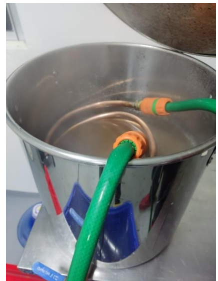
Figura 30. Mosto enfriado con circuito cerrado. Fuente: Elaboración propia.
