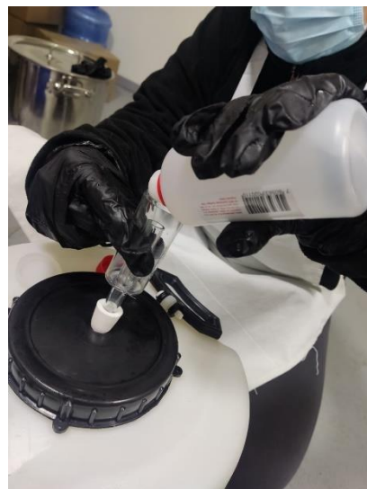
Figura 22. Instalación de la trampa de aire. Fuente: Elaboración propia.
