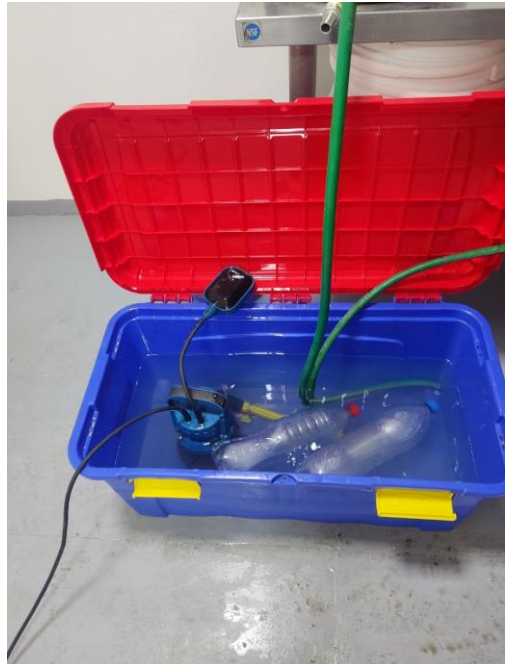
Figura 28. Conexiones en la bomba sumergible. Fuente: Elaboración propia.
