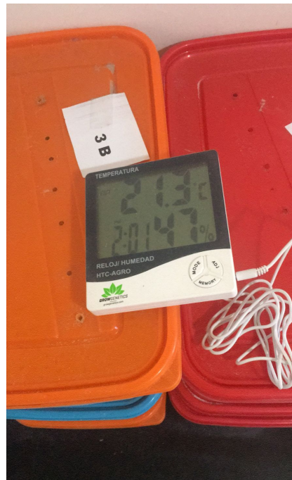
Figura 12. Sistema de monitoreo de humedad mediante higrómetro instalado con sus sensores al interior de una de las cajas.
