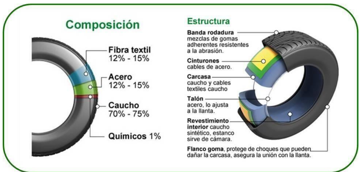
Figura 1. Composición y estructura de un neumático.
