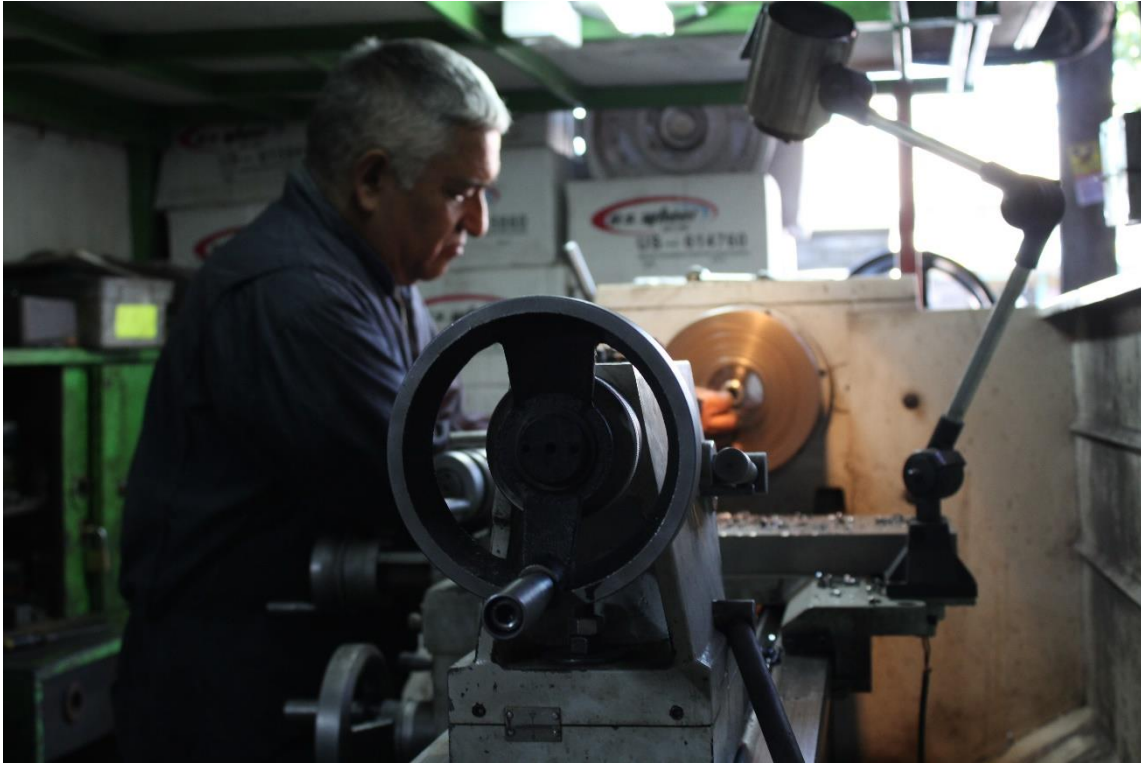
Fig 9. Maestro utiliza un torno para rectificar una pieza interna de un motor de combustión interna. Autor: Alicia Vera García.
