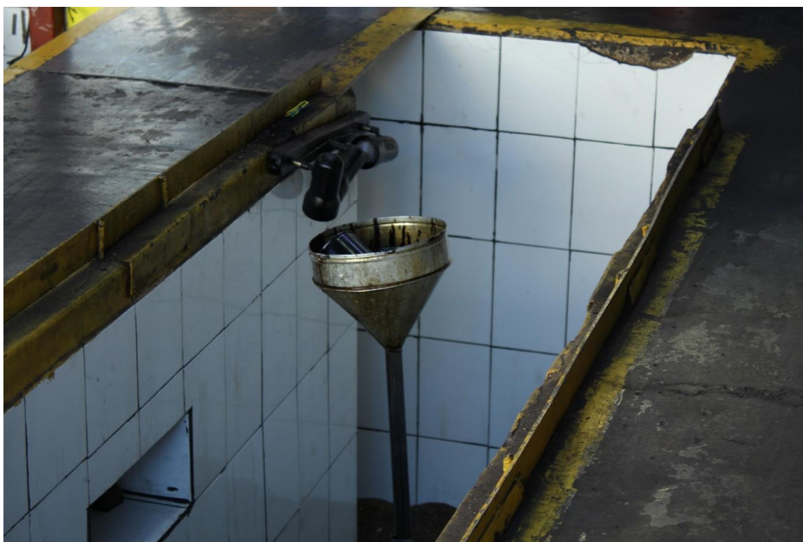
Fig 12. Detalle colector de aceite y pozo. Autor: Alicia Vera García.
