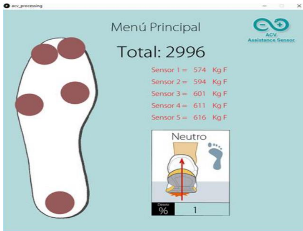
Ilustración 4. Dispositivo indicador de carga de peso y actividad muscular.
