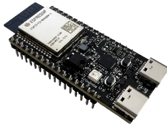
Ilustración 7. Placa de desarrollo ESP32-C5
